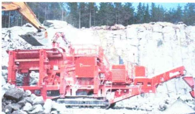
Модульный вариант дробилки Lokotrack LT125, оборудованной гидравлическими стойками для быстрого демонтажа и установки.
