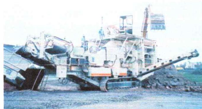
Установки Lokotrack LT125 и LT300GPB, используемые для переработки вторичного сырья (Германия).
